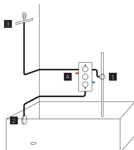
— Warmwasserzufluhr zur Armatur
